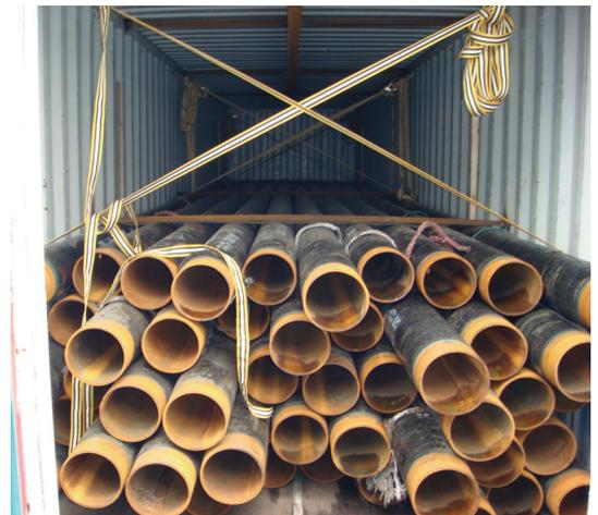
从天津大无缝采办并经过3PE涂敷的API 5L φ219无缝钢管整装待发！
